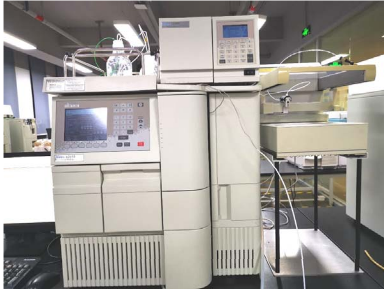
Waters e2695+2489+WFCIII分析级纯化
